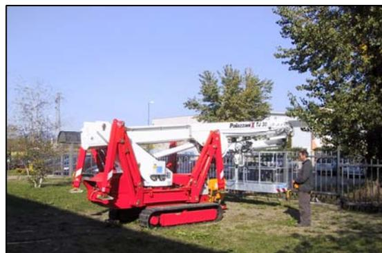
jib telescopico con uno sbalzo superiore a 5 metri per operare anche in negativo
